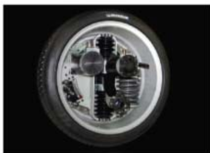
Michelin Active Wheel — Radnabenmotor
