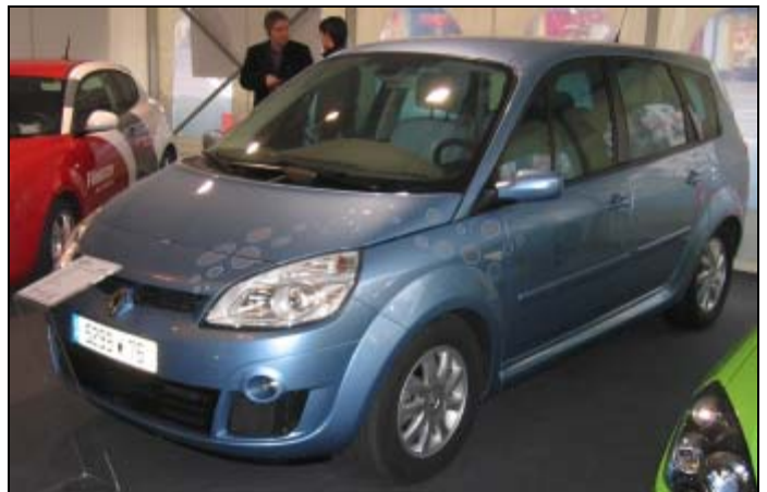
Renault Scénic ZEV H2, Antriebsart: Elektromotor feste Übersetzung, kein Schaltgetriebe, Leistung 90 kW, Lithium Ionen Batterie, Reichweite 350 km, Höchstgeschwindigkeit 160 km/h, Studie
