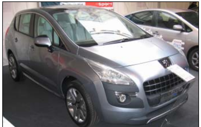
Peugeot Prologue Hybrid, Vierzylinder Diesel + Elektromotor 6-Gang Getriebe, Dieselmotor mit 120 kW, Elektromotor mit 27 kW, CO 2 Ausstoß 97 g/km, Verbrauch 4,1 L Diesel / 100 km, Höchstgeschwindigkeit 209 km/h, Markteinführung 2011
