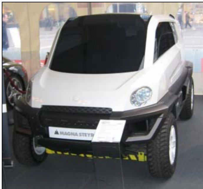
Magna Steyr Mila Alpin, Dreizylinder Benzinmotor mit 64 kW und Elektromotor mit 20 kW, 5 Gang Getriebe, CO 2 Ausstoß 145 g / km, Höchstgeschwindigkeit 140 km/h, Studie
