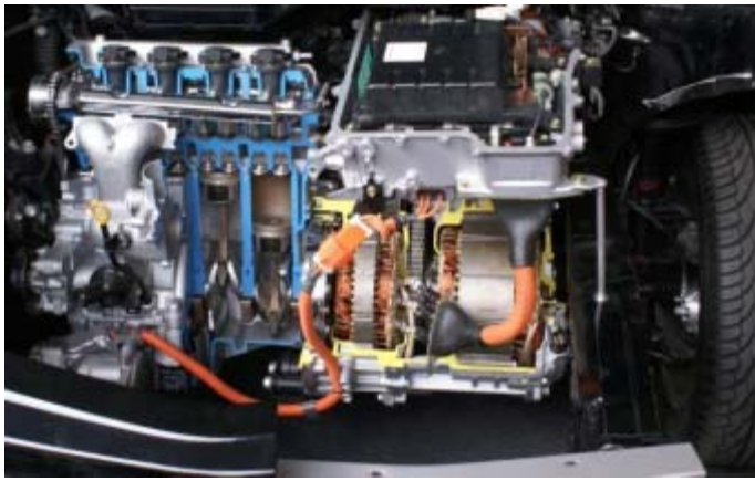
Schnittmodell von der Antriebseinheit des Toyota Prius (Plug-In-Hybrid)
