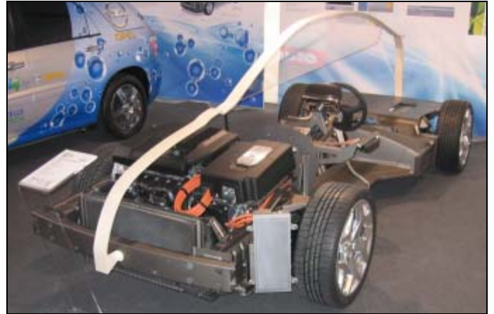
Chevy Volt Fahrgestell mit Antriebseinheit.
