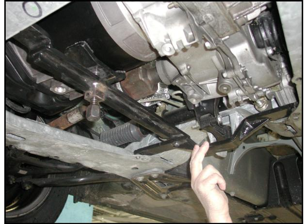
13. Lever le moteur avec l'outil jusqu'au décolllement des supports pour faciliter la dépose de l'écope du CEVE.
