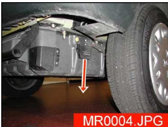
2. Débrancher la batterie 12 V.
