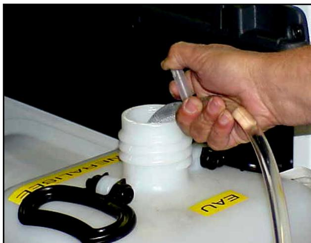
Sur l'appareil de remplissage, raccorder le tuyau d'alimentation en eau distillée sur le raccord repéré **C**.
