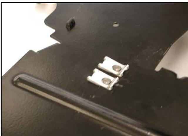
7. Assembler le support et la chaudière et monter les silentblocs (1) sur les pattes du support. La rondelle-entretoise inoxydable (3) est utilisée pour l'assemblage du support sur la chaudière (2).
