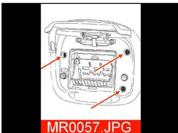
8. Déconnecter le connecteur du verrouillage de trappe et placer le fil sur le côté pour éviter qu'il ne tombe dans la carrosserie.
