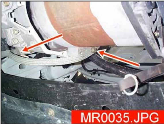
21. Dévisser les 3 vis de maintien (partie supérieure) entre le moteur et la boîte.
