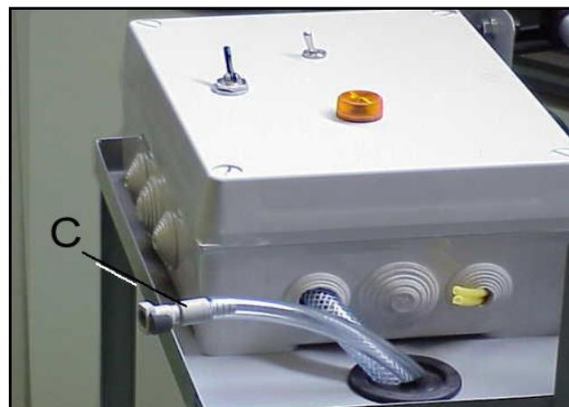
Mettre l'appareil de remplissage sous tension. Le contenu du bocal de dépression est vidangé.
