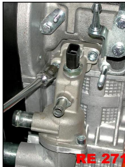
Le clapet du calorstat alors peut être déposé du corps de calorstat en retirant les 2 vis.
