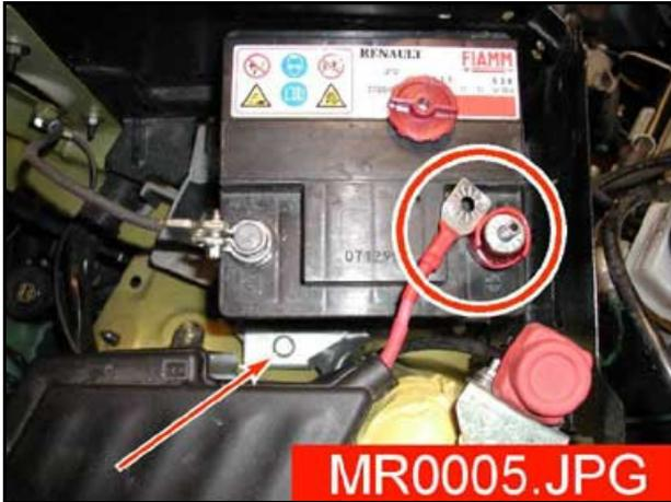
4. Enlever le capot de protection du bornier CEVE en dévissant les 3 vis.
