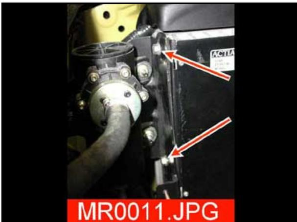
10. Débloquer les 3 vis du support CEVE et dévisser complètement les 4 vis du support moteur.
