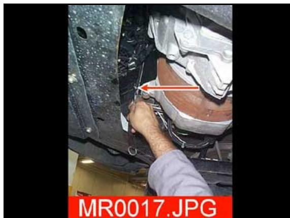
17. Déverrouiller le connecteur 24 voies sous le CEVE et le débrancher.
