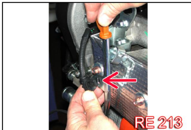
11. Débrancher le connecteur de la sonde de température d'air.
