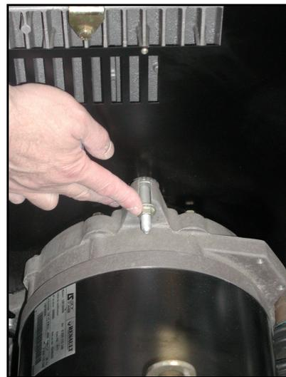
24. Dégager le CEVE (30 Kg) avec une chèvre et le placer sur une table élévatrice.
