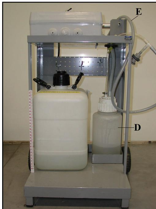
Mettre l'appareil de remplissage sous tension. Le contenu du bocal de dépression est vidangé.
