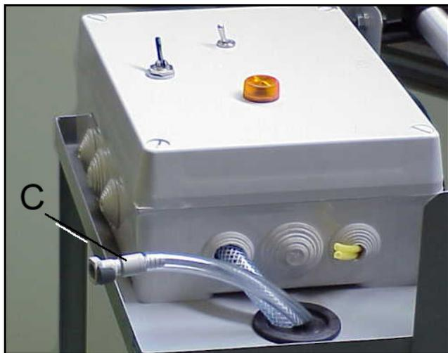
Sur la face avant du boîtier de commande de l'appareil de remplissage, placer l'interrupteur **B** sur la position **Aspiration** et l'interrupteur **A** sur la position **I**.
